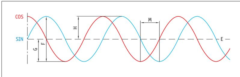
E: Bezugsspannung 2.5 V
