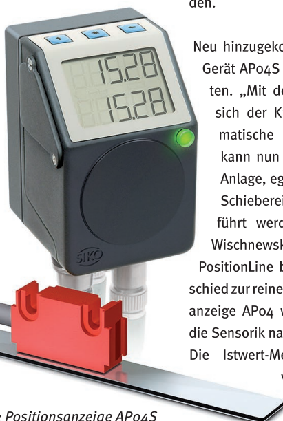
Messsystem: Positionsanzeige AP04S mit Magnetsensor und Magnetband für lineare Positioniereinheiten
